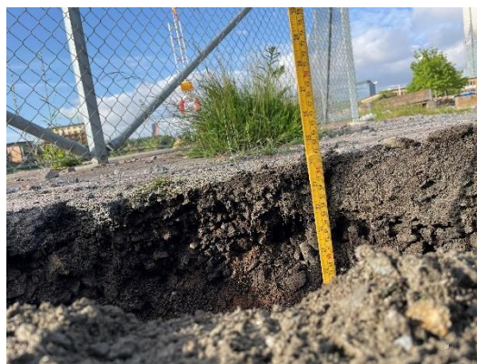
Figur 1-8 Provgrop för verifiering av ballastdjup
