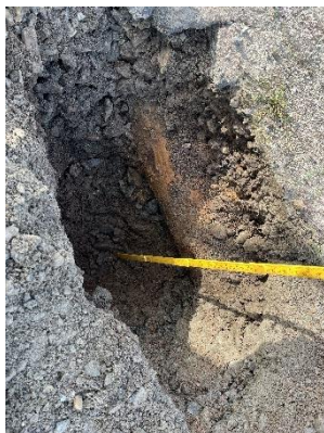
Figur 1-8 Provgrop för verifiering av ballastdjup
