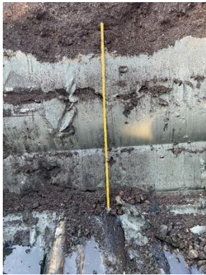
Figur 8-5. Sektion av jordlager i provgropen.
